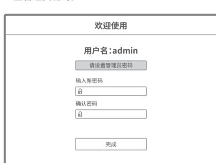
2.首次登录NVR，可配置“设置向导”完成分辨率设置、网络连接、时间校对和添加IPC功能配置。
